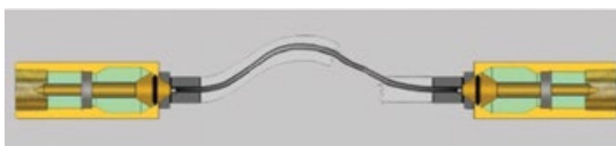
Rupture du tuyaux - Déchirage
